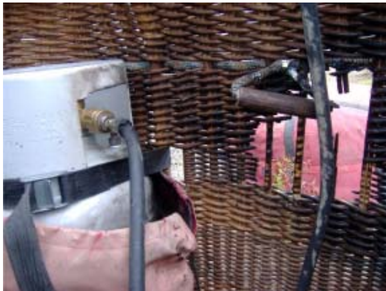
図5 放電したシリンダーの搭載状況再現とコネクター部の損傷とその火炎によるバスケットの焼損部
