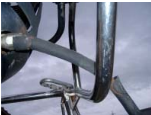
図8 ガスホース，バーナー側の損傷状況
