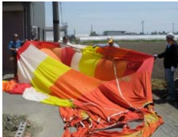
図 16 球皮の損傷状況
