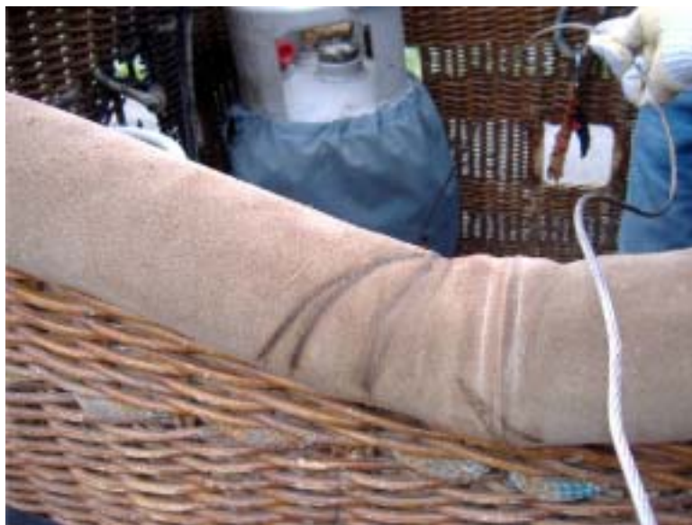
図6 バスケットレザーに残された焼け跡
