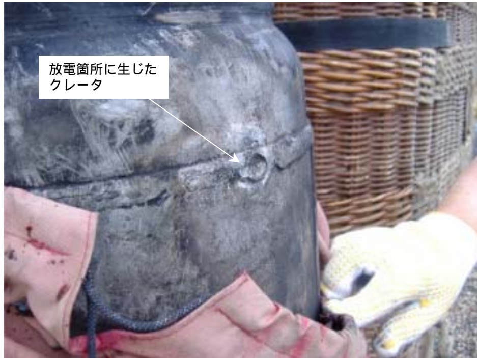
図7 放電したシリンダーの損傷状況
