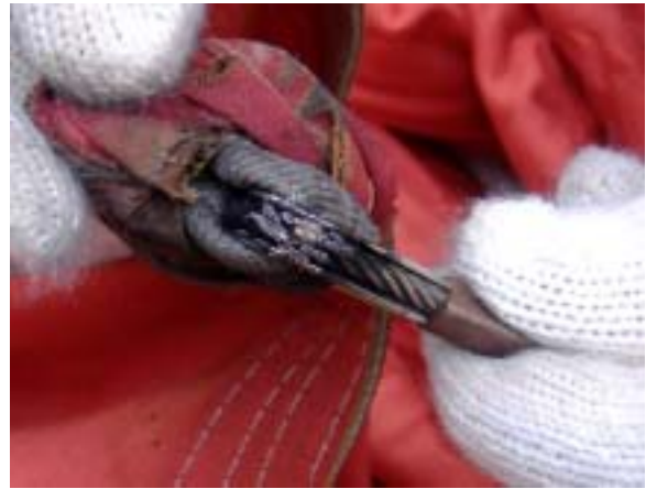
図 14 サスペンションワイヤー機体側切断部
