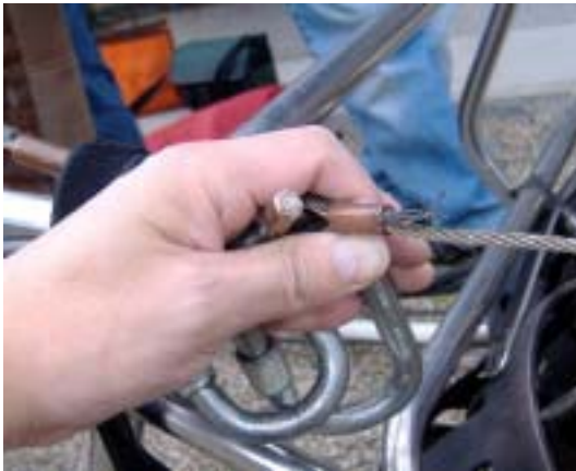
図11 溶断したサスペンションワイヤー（バーナーフレーム側）
