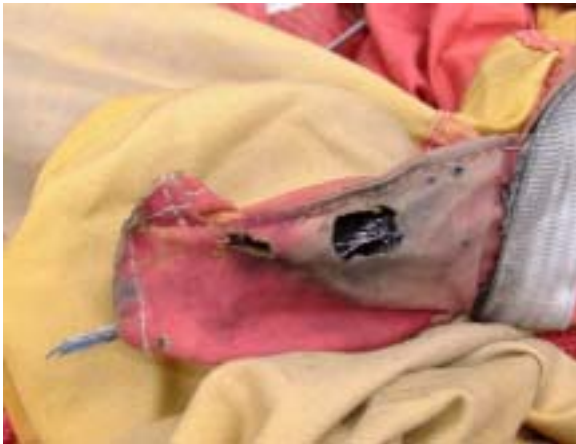
図 13 サスペンションワイヤー機体側の切断箇所
