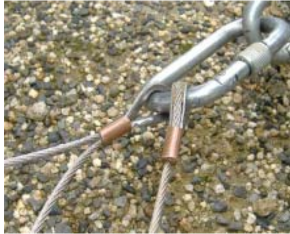
図10 事故機体のサスペンションワイヤー（バーナーフレーム側正常部）
