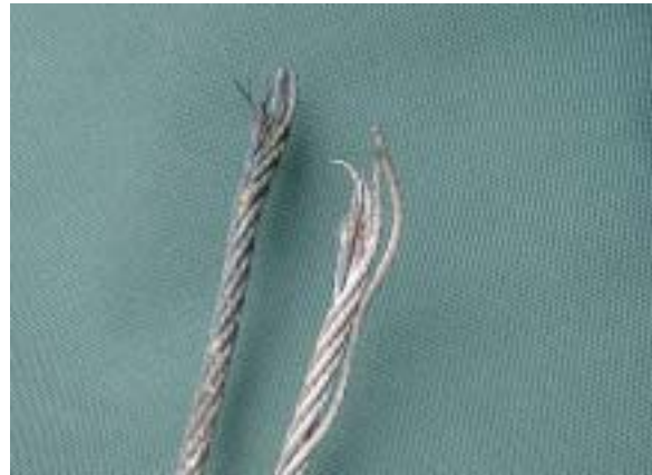
図12 上下で溶断したサスペンションワイヤーの破断状況
