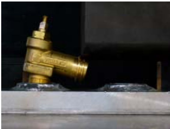
写真 11 ACME タイプバルブの破壊状況
