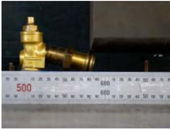
写真 8 NPT3/8 タイプバルブの破壊状況
