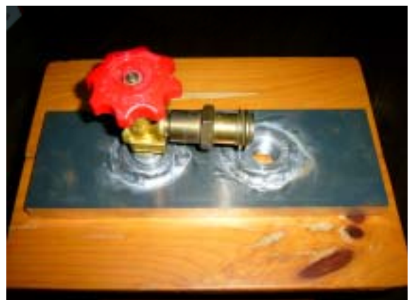
写真 7 固定用治具 (バルブを固定しているアルミ製の板)
