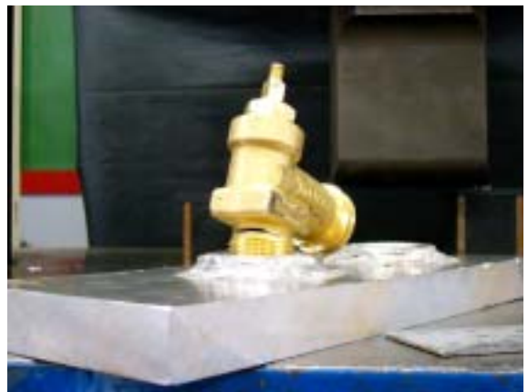
写真 12 ACME タイプバルブの破壊部位
