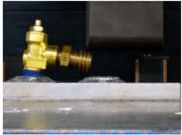
写真 9 POL タイプバルブ 1 の破壊状況
